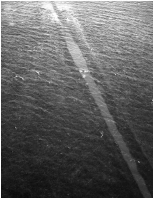
Tydliga spår syns efter nedläggningen av Baltic-Cable som går mellan Sverige och Tyskland. Foto Kristian Nordström.
